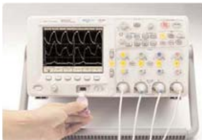
Рисунок 7 - Встроенный порт USB позволяет легко запоминать результаты работы и обмениваться ими, а также быстро обновлять системное программное обеспечение
