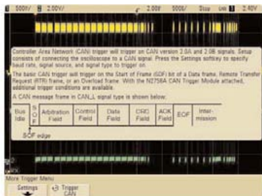
Рисунок 12 - Для получения встроенной подсказки, например, как приведенное выше описание запуска по условиям шины CAN, следует нажать и удерживать соответствующую клавишу
